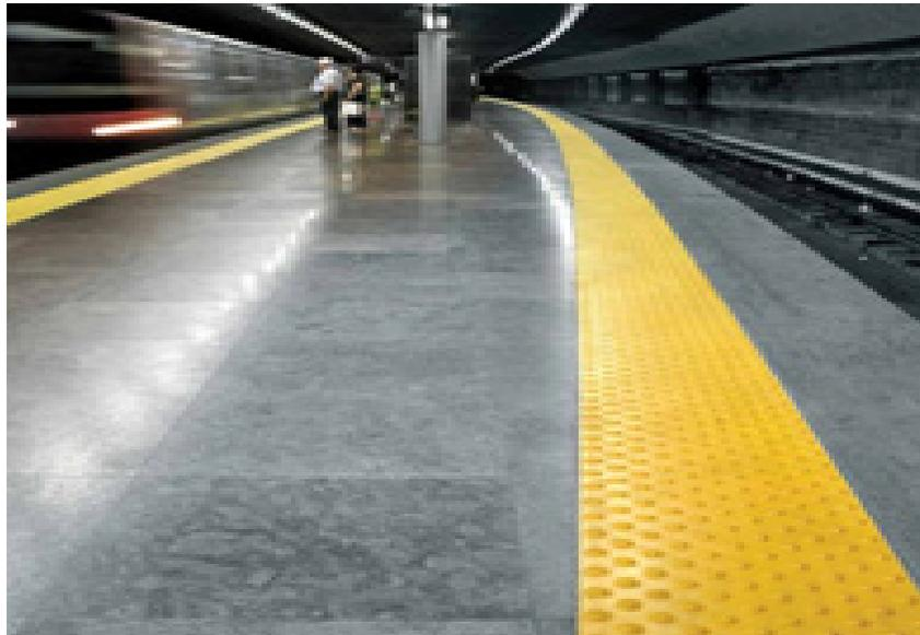
*Fig 17: Sistema de pavimento podotáctil*
